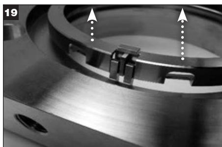
19 Ta bort drivkanalen från glanden. Ta bort kanalklämmorna och flödesdetektorn från kanalen och kassera dem.
