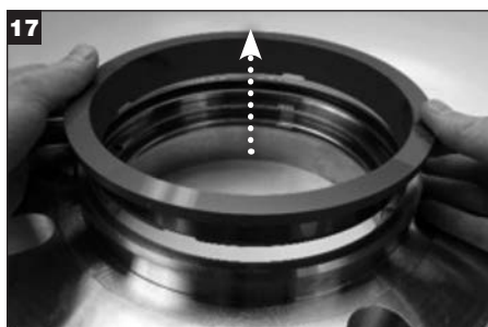
17 Ta bort den invändiga, stationära tätningssytan från glanden och kassera den.
