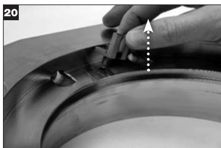
20 Ta bort drivanordningen från glanden och kassera den.
