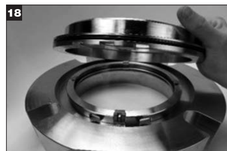
18 Ta bort adaptern från glanden. Avlägsna adapternas o-ring (Z) och kassera den. Ställ adaptern åt sidan.
