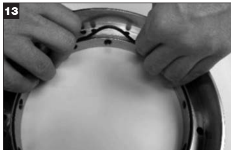
13 Ta bort låsringen till o-ringen (Y) och kassera den.
